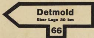
Wegweiser für Fernverkehrsstraßen. Anordnung der Straßennummern oben oder unten ist freigestellt.
